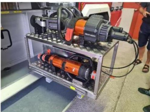
Nach aufwändigen Umbauarbeiten in Eigenregie, konnte das hydraulische Rettungsgerät nun so im Fahrzeug eingebaut werden, dass es rasch und unkompliziert für einen Einsatz entnommen werden kann.
